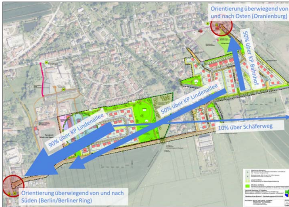
Abbildung 1: Kleinräumige Orientierung der Verkehrsströme
